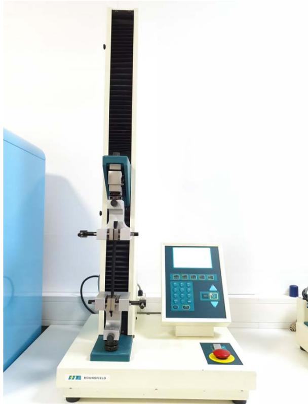
Die H5kS ist eine nach neuesten Gesichtspunkten entwickelte Universalprüfmaschine. Die Maschine arbeitet nach den in der EG relevanten Strahlenschutz- und Sicherheitsrichtlinien. (EN 50081-1, 72/23/EEC, EN 61010-1) Die maximale Spannung innerhalb der Maschine beträgt 48 Volt.
